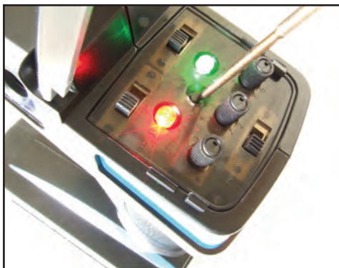
Quand vous avez allumé votre radio vous pouvez relâcher le bouton "blind", la LED verte va se mettre à clignoter pour vous indiquer que l'opération de couplage est en cours.
